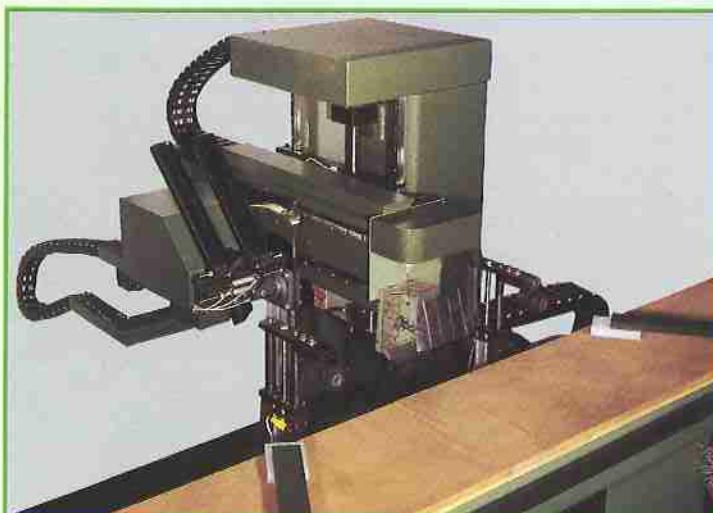
De DOR-FLEX is opgebouwd met een verticale en horizontale freesmotor van 3 pk (optie 7 pk) voor het uitfrezen van scharnieren, slotplaten, sloten, puntsluitingen en alle soorten standaard beslag.
