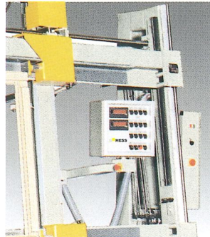
HESS Centro Motorisch: Die Verstellung auf das neue Arbeitsmaß erfolgt nach Entnahme des verleimten Werkstücks motorisch über Tipptaster. Digitale Maßanzeige.
