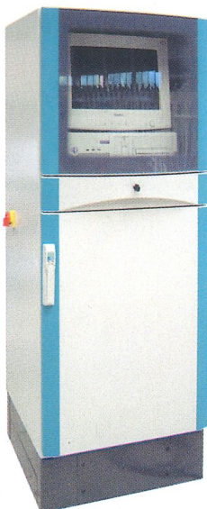
HESS Centro Leser: Externe Maßvorgabe aus dem computergesteuerten Fertigungsablauf (Vormaschine, Zentral-Computer o.ä.) schon während eines ablaufenden Pressvorgangs. Durch Entnahme automatische Verstellung auf das neue Arbeitsmaß.
