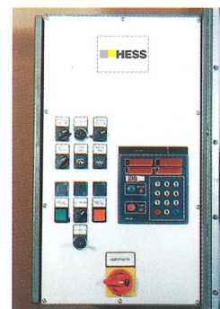
HESS Centro Digital: Maßvorgabe über Tastatur nach der Zuschnittsliste während eines ablaufenden Pressvorgangs; automatische Verstellung auf das neue Arbeitsmaß durch Entnahme des verleimten Werkstücks.
