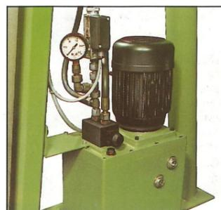
Automatische Enddruckab- und Nachschaltung einschl. Arbeitssicherheits-Einrichtung (Zubehör)
