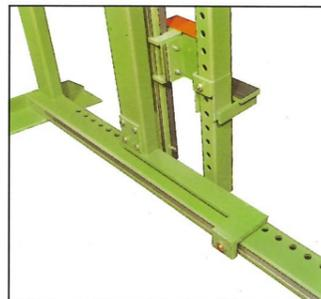
Präzisionslochraster. Schiebeschlitten mit extrem langer Abstützlagerung mit Messing-Gleitführung zur Aufnahme der Druckkräfte.
