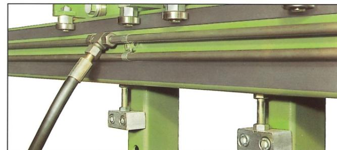
Die leise Hydraulikanlage (unter 68 dBA) mit automatischer Enddruckabschaltung sowie Sicherheitsüberdruckventil und wärmeableitendem Alubehälter sind Voraussetzung für Sicherheit, Langlebigkeit, Kostenersparnis.
