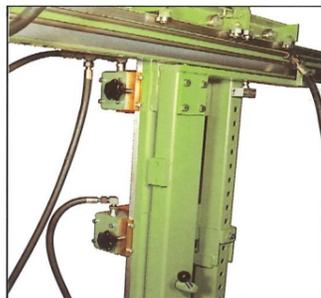
Auf 1/10 mm genau gehobelte Führungsträger und doppelt kugelgelagerter Schiebeschlitten garantieren fingerleichtes Verschieben und Parallel-Zwangsverriegelung mit einem Griff.
