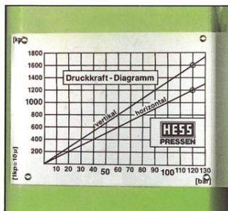
Das Druckkraft-Diagramm zeigt Ihnen, daß Sie stufenlos – je nach Arbeit – jeden gewünschten Druck, von 30–120 bar, einstellen können.
