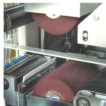
integrierte Bürst- und Finisheinrichtung (Zusatzausrüstung). Für besseres Oberflächenfinish, Werkstück-/Abblase-Einrichtung mittels Flachstrahlröhren.
