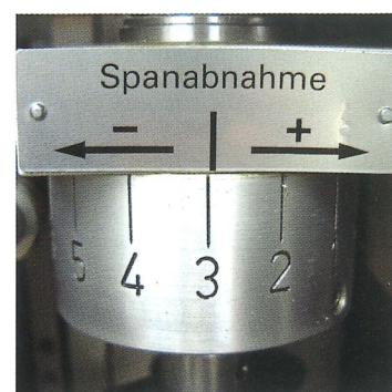
Maßanzeige für die untere Spanabnahme über Skala, Auflösung 0,1 mm
