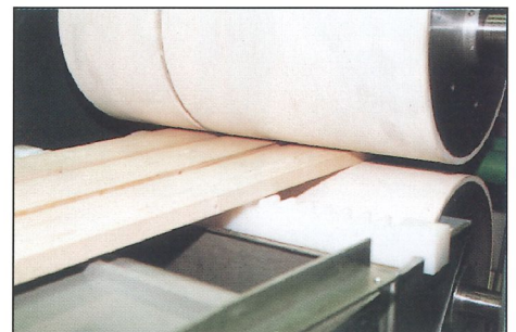
Ein- oder zweiseitiger Leimauftrag über zwei gummierte Walzen
