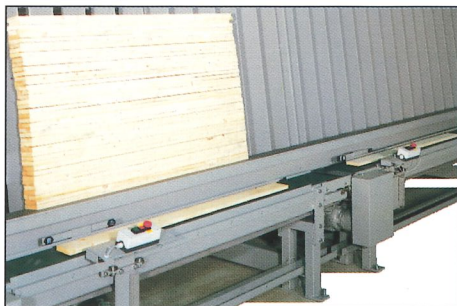
Vorgebautes Stollenförderband mit frei positionierbarem Lamellen-"Stopp"
