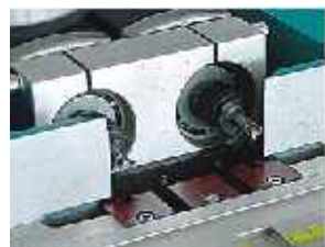
Fräsgruppe mit Spindelabstand 65 mm
