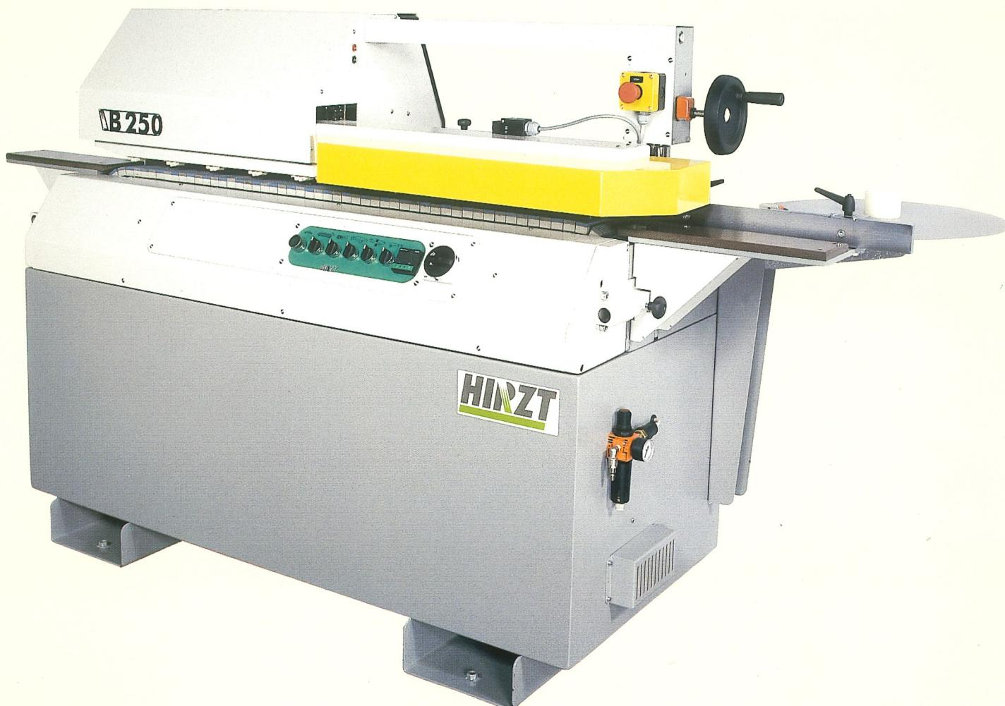
Automatische Kantenanleimmaschine fuer vorbeschiteten Umleimer 0,4-3 mm
