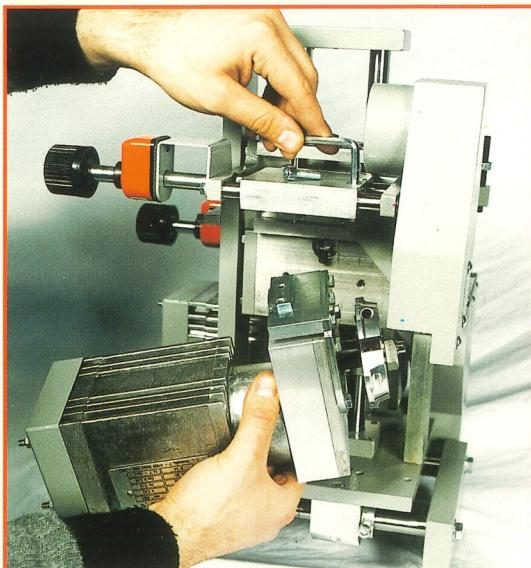
**Buendigfraesmotor**, schnell fixierbar um einfachen Werkzeugaustausch zu ermoeglichen und automatischer Neupositionierung des Motors ohne Einstellung
