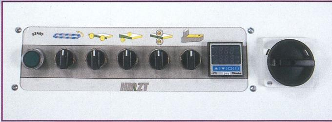
**Quadro comando** con visualizzatore e programmatore digitale della temperatura della vasca colla, con sistema di stand-by in caso di non utilizzo della macchina.
