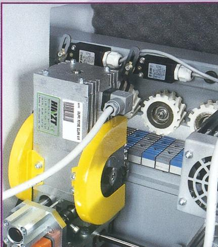
**Intestatore** ad aggancio e rincorsa con motore bilama per eseguire il taglio del bordo eccedente dal pannello anteriore e posteriore. Tutte le movimentazioni sono su guide temperate rettificate con cuscinetti a ricircolo di sfere rendono l'intestatura precisa e costante nel tempo.
