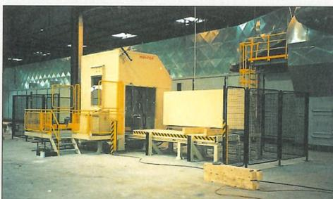
Anlagen zum Kappen von Gipskartonplatten
