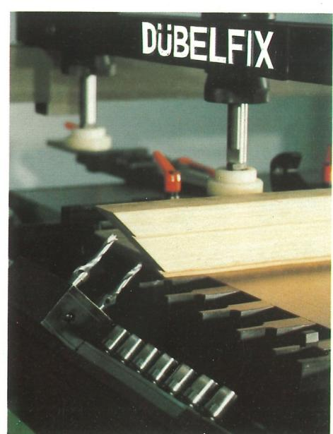
Aufsteckgetriebe im 45° Einsatz
