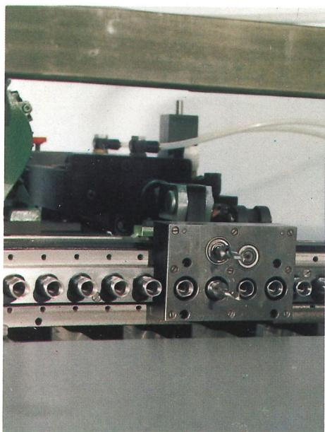
Aufsteckgetriebe für Sonderbohrungen
