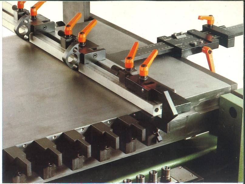
Die neue Anschlagkombination garantiert größte Präzision, da alle Anschläge über Nonien auf 0,1 mm genau eingestellt werden. Seiten- und Längsanschlag finden auch als Queranschlag für endlose Reihenbohrungen Verwendung.
