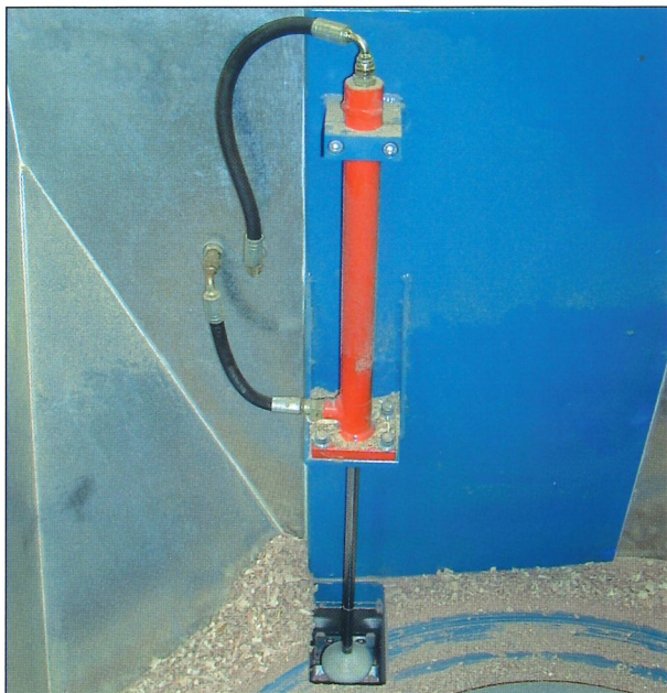
Hydraulischer Stopfzylinder für sichere Beschickung
