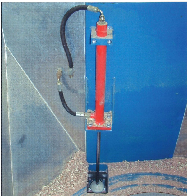
Hydraulischer Stopfzylinder für sichere Beschickung
