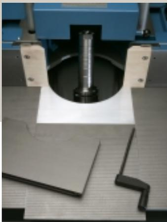
**Im Detail raffiniert.** Der Frästisch mit Tischeschieber und eingebautem Vorsatz (Hard-Coat beschichtet und damit verschleißfrei) für Werkzeuge bis  $\varnothing$  250 mm für schnelle und sichere Einstellung der Tischöffnung. Die Zweiteilung in Vorsatz und Zwischenstück mit Schnellverschluss sorgt für problemlose Bedienung bei unterschiedlichen Werkzeugdurchmessern. (Option: Vorsatz  $\varnothing$  160 mm beiliegend).
