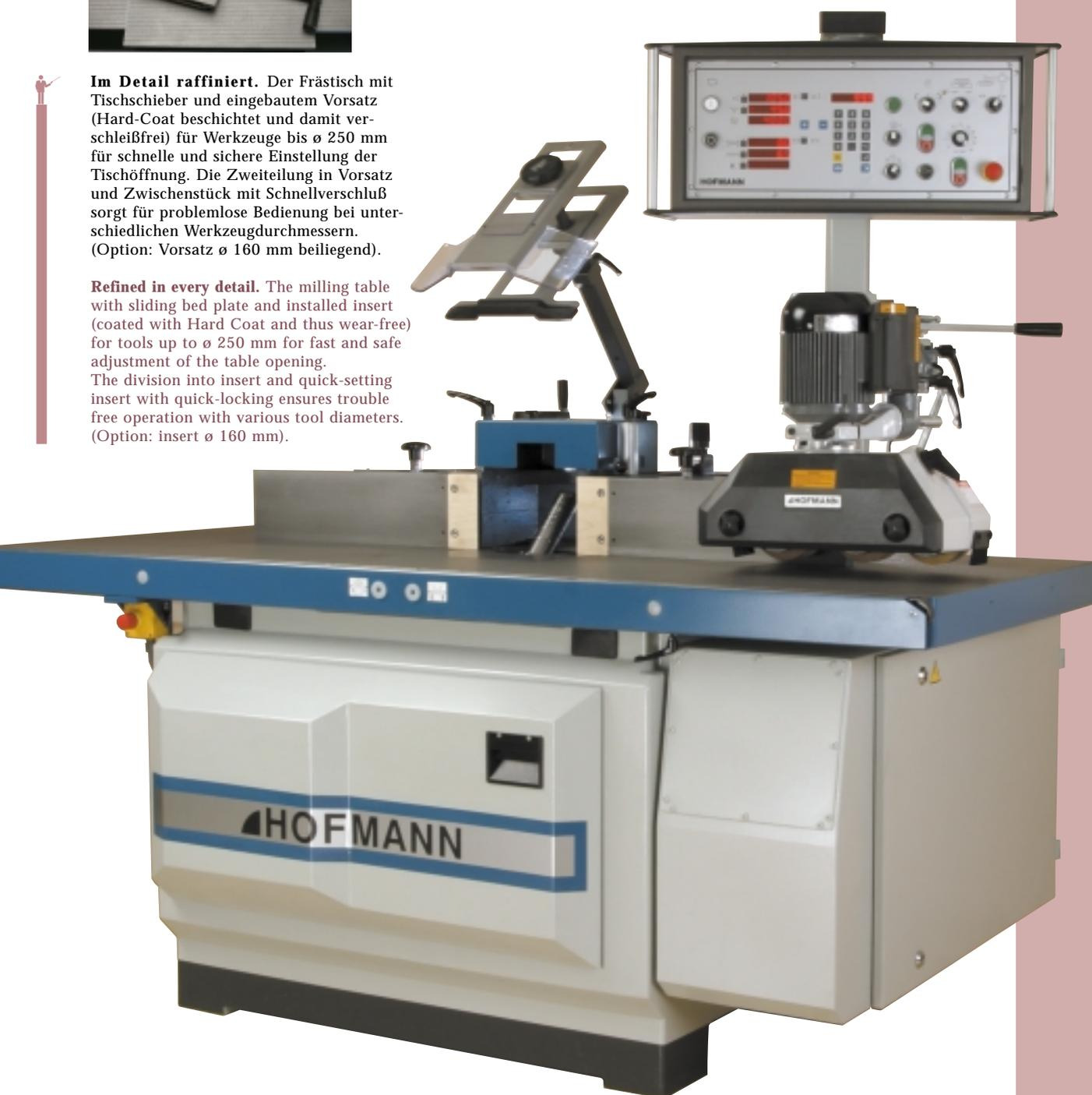
**TFS 1245 Automatik** mit Schaltpult nach oben und Funktionsstativ. Tischgröße 2050 mm mit Schieber, Fräsanschlag Typ 2610 und Vorschubapparat Typ 308.
