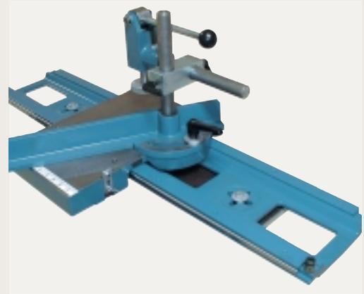
**Präzississimo.** Der Schiebeschlitten zum Zapfenschneiden und Schlitzen, für kürzere Werkstücke, läuft auf gehärteten Führungswellen mit nachstellbaren, hochpräzisen Laufrollen.
