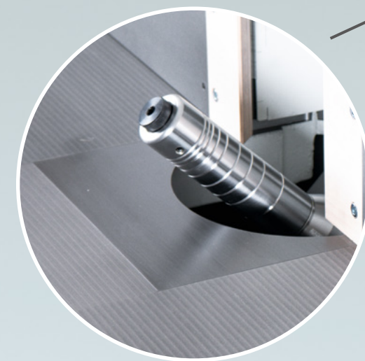
Tisch mit Tischeschieber zur schnellen und optimalen Anpassung der Tischöffnung an das Werkzeug
