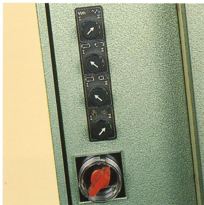
Arbeitstaster für Sägemotor und Vorschubmotor getrennt mit Sicherheitsschalter gegen Fehlbedienung – Not-Ausschalter.
