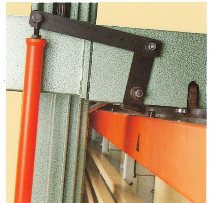
Feste Raststellen zum Einrasten des Sägewagens oben und unten gleichzeitig, damit ein absoluter Winkelschnitt gewährleistet ist.
