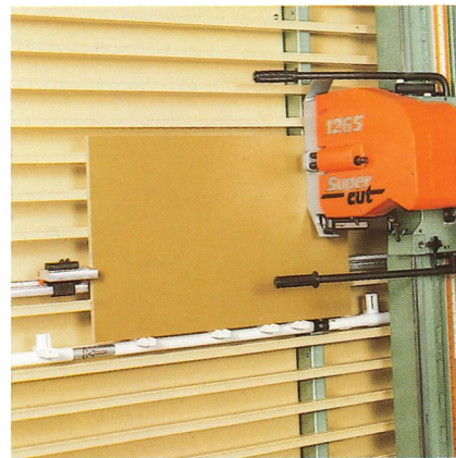
Klappschienen zum Schwenken und Rasten, einzeln geteilt für jedes Schnittfeld, damit Sie grössere Restplatten nicht immer abräumen müssen. Maßschienen in Blickrichtung, Klemm-Anschlag für Einband-Bedienung.
