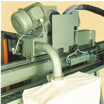
Integrierte Staubabsaugung hoher Wirkungsgrad durch kurzen und direkten Verbindungsweg zum Staubauffang sack.
