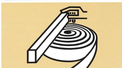
Kantenzuführung halbautomatisch Kantenlänge min. 200 mm Kantenhöhe max. 51 mm Kantendicke einzeln 0,3 – 25 mm für Rollenware 0,3 – 0,8 mm Rollendurchmesser max. 500 mm
