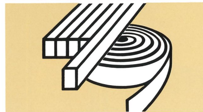
Kantenzuführung automatisch Kantenlänge min. 350 mm Kantenhöhe max. 51 mm Kantendicke einzeln 0,3 – 25 mm für Rollenware 0,3 – 0,8 mm Rollendurchmesser max. 500 mm
