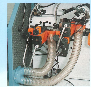
Multifunktionsaggregat 1942 M (2 x 0,6 kW; 18 000 min -1 ): zum Bündig-, Radius- und Fasefräsen ohne Werkzeugwechsel, horizontale und vertikale Tastung, schwenkbar bis 15 Grad.
