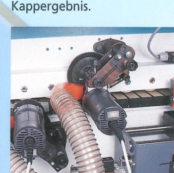
Fräsaggregat 1975 (2 x 0,6 kW; 28 000 min -1 ): zum Bündigfräsen, ausgestattet mit einer horizontalen und vertikalen Tastung und Schnellkupplung.
