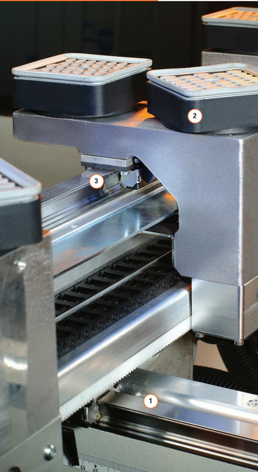
La VarioTable consta de seis consolas con tres ventosas escamotables cada una. **El cambio del conjunto de la mesa de trabajo tiene lugar en tan sólo 15 segundos.** Consolas y ventosas se colocan automáticamente por medio del comando.
