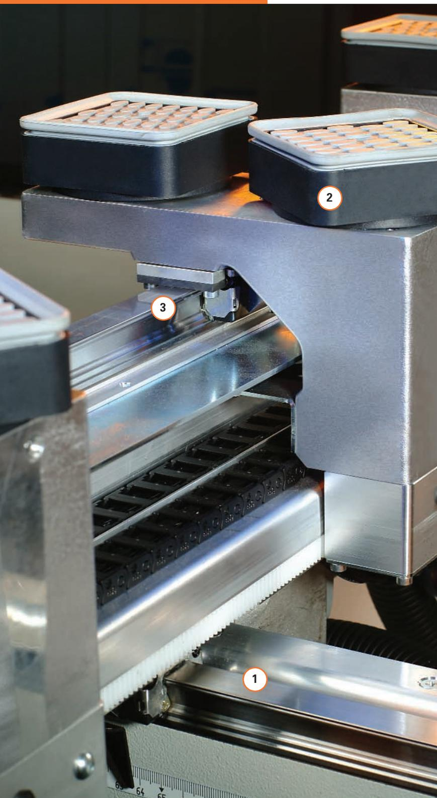
VarioTable è costituito da sei console, ognuna con tre aspiratori mobili. **La riparazione dell'intera tavola di lavoro avviene in meno di 15 secondi.** Le console e gli aspiratori vengono posizionati automaticamente mediante il controllo.
