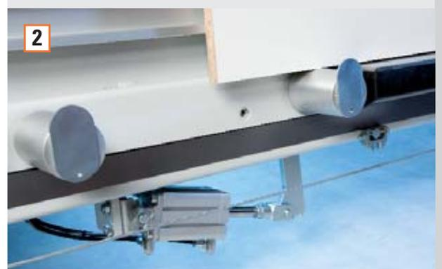
Automatisches Absenken der Rollen beim Eintauchen des Sägeblattes für absolute Präzision des Schnittmaßes [Bild 2].
