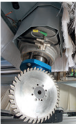
C-Achse (0-360°) für den Einsatz von Aggregaten
