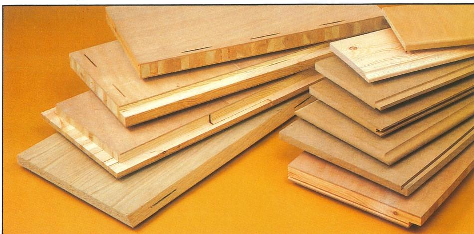
Die links und auf der Titelseite abgebildeten Platten und Profile zeigen einen kleinen Querschnitt der vielfältigen Bearbeitungsmöglichkeiten, die Ihnen der Optimat Doppelendprofiler bietet. Diese und viele weiteren Bearbeitungen von Plattenkanten können Sie wirtschaftlich, schnell und zuverlässig in Homag-Qualität durchführen.
