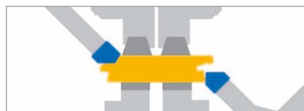
Pneumatisch einstellbarer Rollenhebel über Motormitte (nur Längsmaschine)
