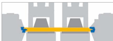
Präzisionskette unten, innenliegende Druckschuhe oben
