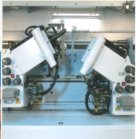
Formfräsaggregat FK 11/FK 13 Zum Bearbeiten der Kantenüberstände. Auch zum Umfräsen der Vorder- und Hinterkante. Optionen: Verstellung Fase / Radius mit stufenloser Achse oder manuell.
