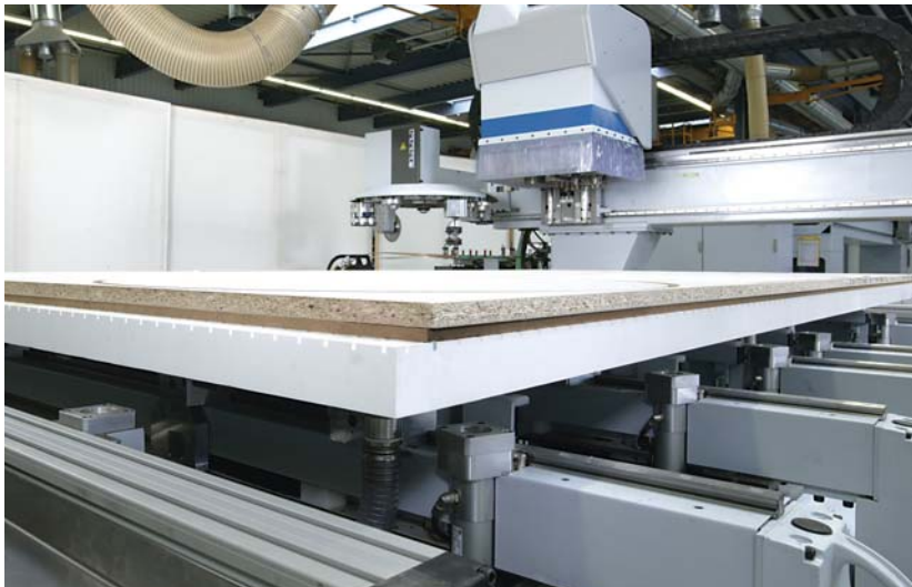
Die Rohplatten (bis zu 2.800/2.100 mm) werden auf eine MDF-Verschleißplatte gelegt.
