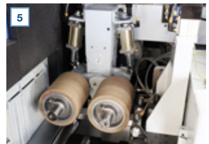
Gummierte Oberdruckrollen zum Schutz des Werkstückes nach der oberen Bearbeitung (Shore Härte: 80)
