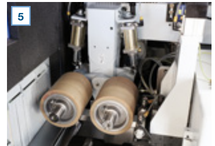
Gummierte Oberdruckrollen zum Schutz des Werkstückes nach der oberen Bearbeitung (Shore Härte: 80)
