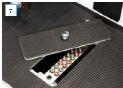
Zugängliche Zentralschmierung an der Maschinenvorderseite
