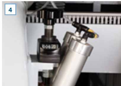
Nachverfolgung der radialen Werkzeugposition mittels mechanischer Anzeige
