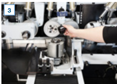
Einfacher und schneller Werkzeugwechsel mit bewährter ProLock-Spindelklemmung
