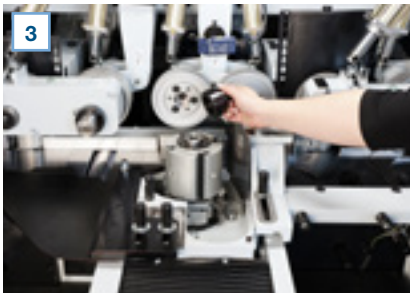
Einfacher und schneller Werkzeugwechsel mit bewährter ProLock-Spindelklemmung
