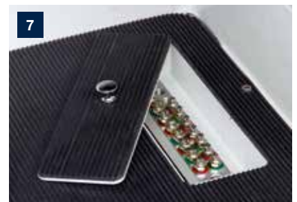
Zugängliche Zentralschmierung an der Maschinenvorderseite
