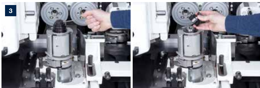
Einfacher und schneller Werkzeugwechsel mit bewährter ProLock-Spindelklemmung
