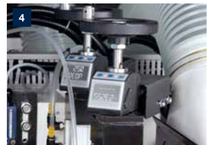
Radiale Verstellung mittels elektrischer Anzeige, für automatische Anzeige und Rückkopplung des Soll-Ist-Vergleichs sowie des Korrekturfaktors
