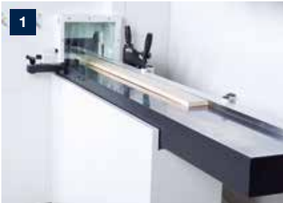
Verchromter Abrichttisch manuell einstellbar
