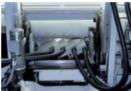
El "corazón" de print line : El cabezal impresor en cuatricromía
