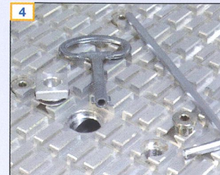
4 1" Vakuumanschlüsse mit Schnellöffnung mittels Schaltschlüssel, Vakuumöffnungen mit Feingewinde zur Befestigung von Spannmitteln
