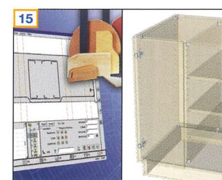
15 woodWOP 5.0 das weltweit am häufigsten eingesetzte Programmiersystem mit woodDesign als 3D-Konstruktionswerkzeug für den „kürzesten“ Weg von der Zeichnung zum fertigen Maschinenprogramm
