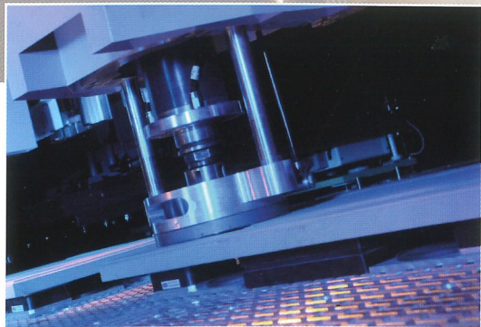
SensoFlex-Tastsystem für die hochpräzise Bearbeitung z. B. von Möbelfronten
