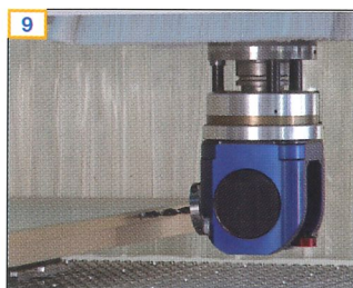
9 Schnittstelle für das FLEX5-Fünf-Achs-Aggregat
