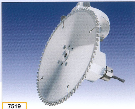
7519 Säge-/Bohraggregat 2 Spindeln: zum Nuten, Bohren und Sägen (auch für Gehrungsschnitte). Als Säge-/Kappaggregat (7513) mit Schnitttiefe bis 110 mm
