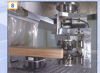
8 Interpolierende C-Achse 360°: um die Aggregate in beliebigem Winkel drehen zu können, inkl. Druckluftübertragung in die Aggregate (z. B. für getastete Aggregate)
