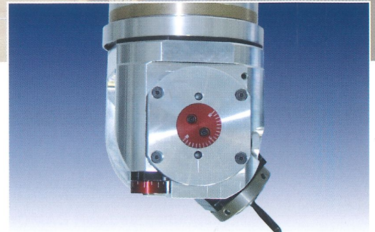
Hochflexibles FLEX5 Säge- und Bohrergagrat für die Fünf-Achs-Bearbeitung
