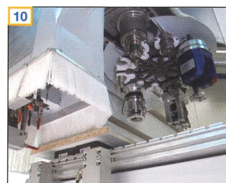
10 Schneller Tellerwechsler (in X/Y-Richtung mitfahrend) mit 10 großen Plätzen für Werkzeuge und Aggregate mit einem Durchmesser von bis zu 190 mm
