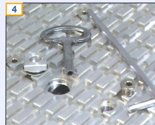
4 1" Vakuumschlüsse mit Schnellöffnung mittels Schaltschrankschlüssel, Vakuumöffnungen mit Feingewinde zur Befestigung von Spannmitteln
