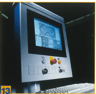
13 power control Steuerung PC 85: mit schwenkbarem Bedienpult für die einfache Maschinenbedienung durch Features wie Graphische Werkzeugdatenbank und Maschinendatenerfassung (MDE)
