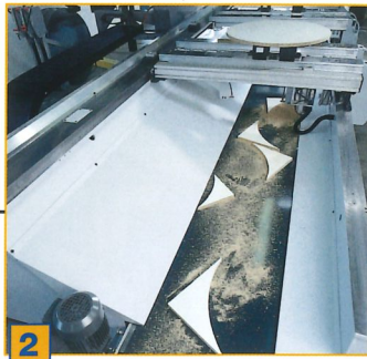
2 Arbeitsfeld von X=4.175 mm und Y=1.730 mm (optional 2.075 mm mit Nebenspindel) mit Reststückentsorgung über das glatte Maschinenbett (optional mit Späntransportband)
