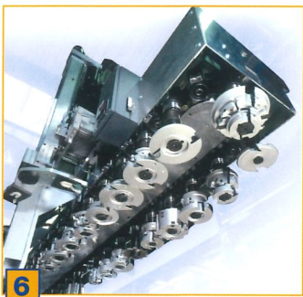
6 Schneller Kettenwechsler mit 30 großen Plätzen für Werkzeuge und Aggregate mit einem Durchmesser von bis zu 180 mm
