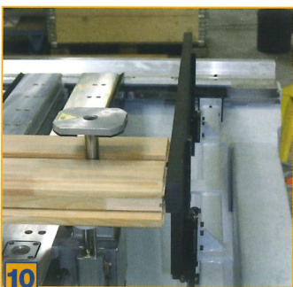
10 Anschlaglineale zur exakten Positionierung der Werkstücke in X-Richtung, unabhängig von der Teilezahl oder Teilebreite
