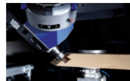
Fräsen einer Gratverbindung für Pfosten-/Riegelkonstruktionen
