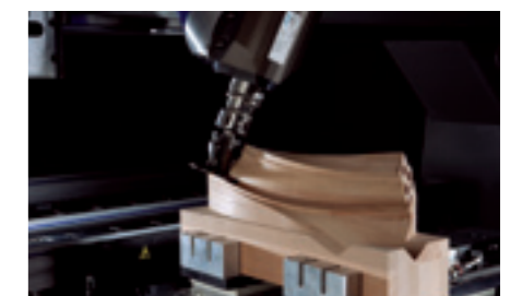
Fräsen eines Treppen-Handlaufs
