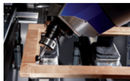
Eckiges Ausspitzen einer Glasfalz-Ecke
