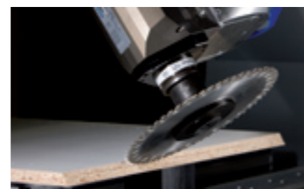
Ausrissfreie und präzise Gehrungsschnitte und Fräsen schräger Nuten für eine Plattenverbindung
