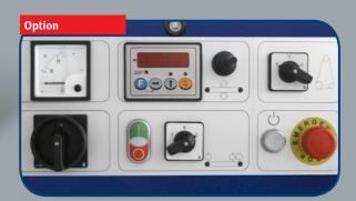
· elektronische Abmessung der Tischposition mit Digitalanzeige (Art.-Nr. 534 3072)
