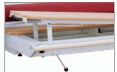
■ der hochklappbare geteilte Schleiftisch der LBSM 2505 ES ermöglicht spezielle Kantenschleifarbeiten
