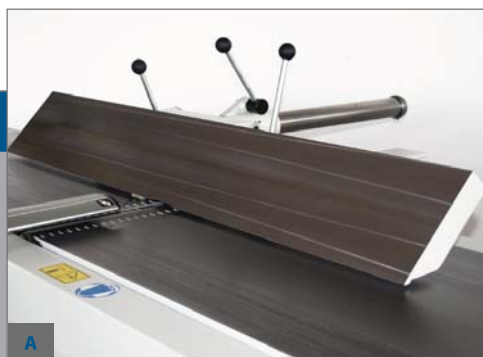
A - NAKLÁPĚNÍ ÚHLOVACÍHO PRAVÍTKA
