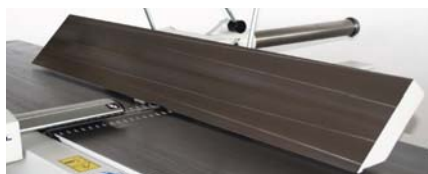
NAKLÁPĚNÍ UHLOVACÍHO PRAVÍTKA
