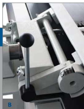
B - NASTAVENÍ ÚHLOVACÍHO PRAVÍTKA
