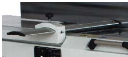
KRYT HOBLOVACÍHO VÁLCE
