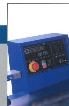
O: OBERES STEUERUNGSPANEEL
