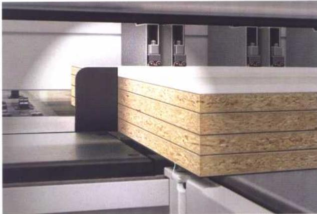
Zentrale Winkelranddruckvorrichtung. Einstellbare Kraft und Präzision genau auf den Punkt.
