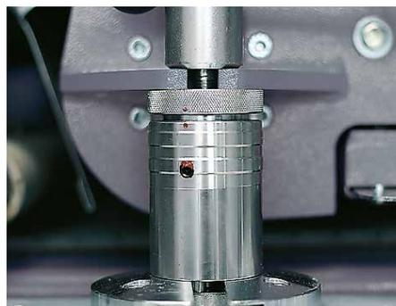
Support de la bande abrasive avec réglage mécanique fin
