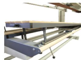
Dispositif d'inclinaison longitudinale de la table
