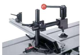
Guide d'onglet et presseur excentrique
