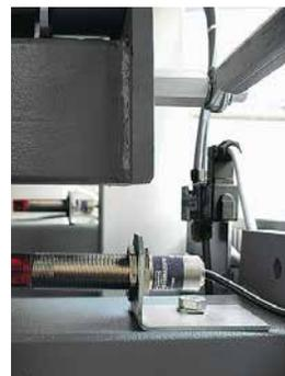
Guidage de l'oscillation de la bande abrasive par rayon infrarouge
