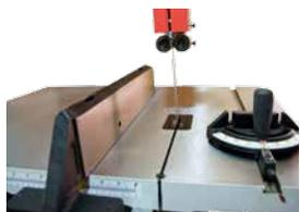
Table en fonte inclinable avec guide parallèle et guide d'angle HBS630
