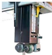
Guide inférieur et supérieur 3 roulements
