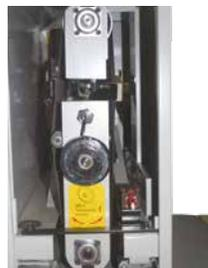
Dispositif de tension de la bande
