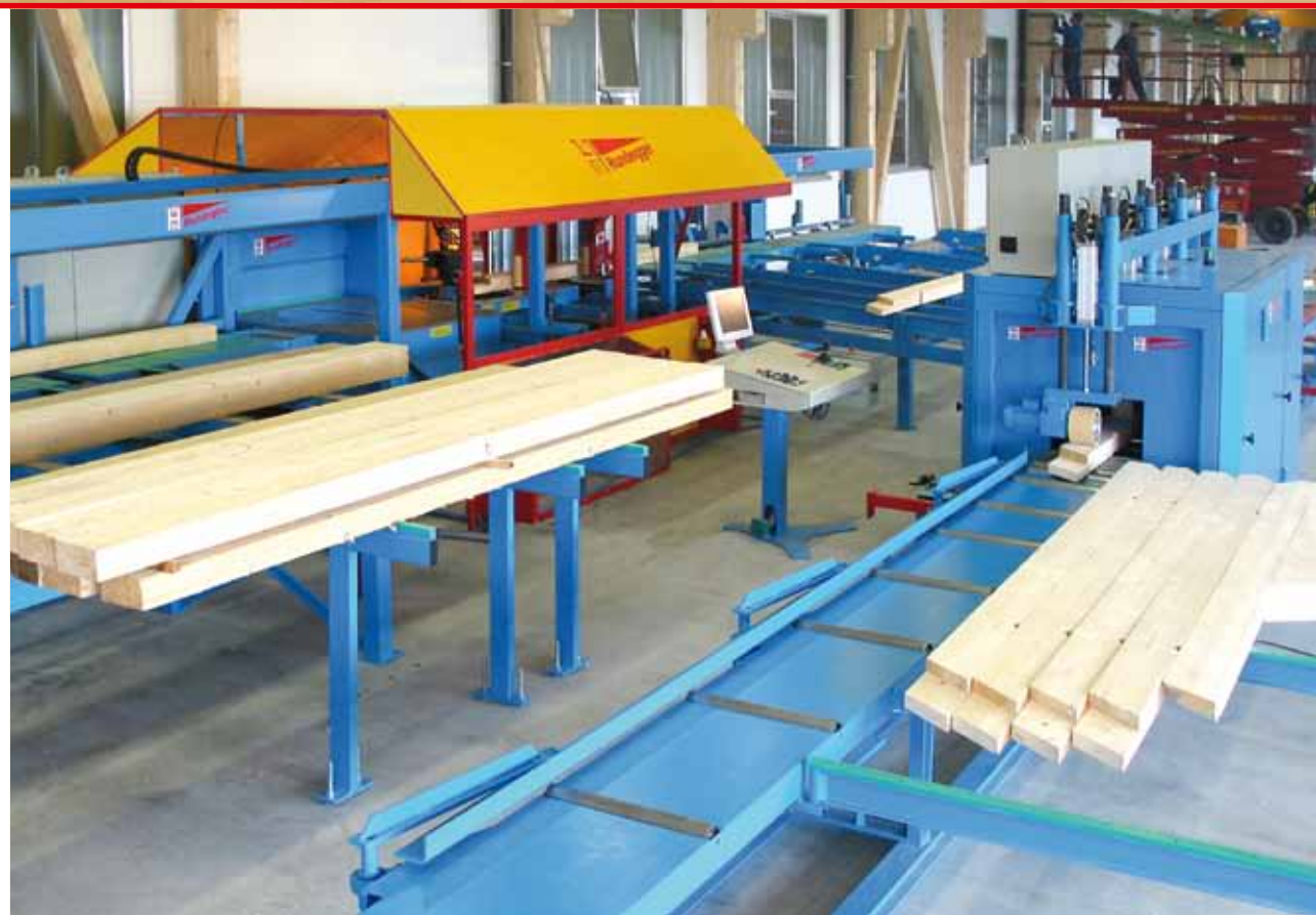
Hobelmaschine mit automatischer Zuführung Строгальный станок с автоматической загрузкой
