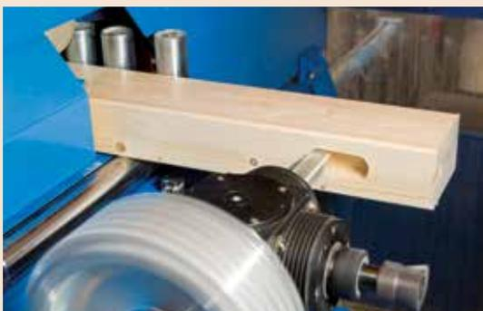
Rationell und sehr präzise fräsen: Längsfräsungen, Traufschalungsausklüngen und Längsausfällungen.
