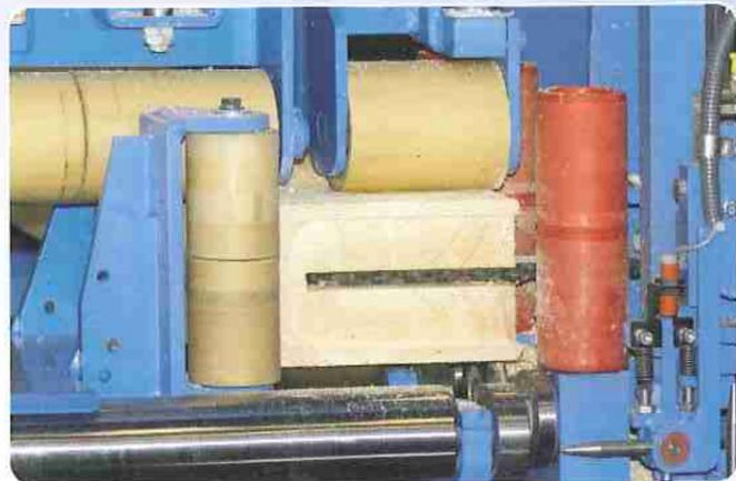
La tronçonneuse horizontale peut être équipée de chaîne de différentes épaisseurs. On pourra effectuer aussi bien des entailles débouchantes ou borgnes comme par exemple pour les pieds de poteaux..
