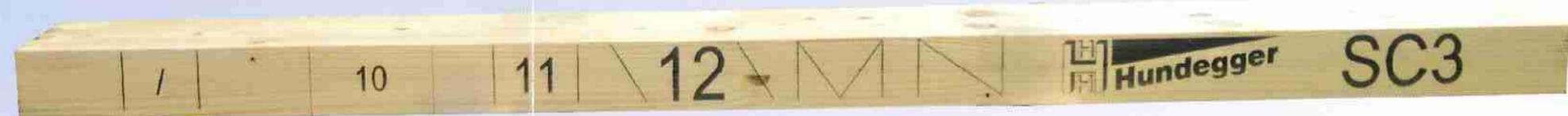
Pour le repérage et le marquage des pièces de bois, différentes solutions sont à disposition, comme par exemple des marqueurs verticaux ou horizontaux, ou des appareils d'écriture verticaux ou horizontaux. Des dispositifs de repérage par Jet encre arrière ou avant sont également disponibles. La hauteur des polices est de 12,7 mm jusqu'à 50,8 mm (de une jusqu'à 4 lignes), Le marquage par jet d'encre se fait en temps masqué, On peut également imprimé un code barre,
