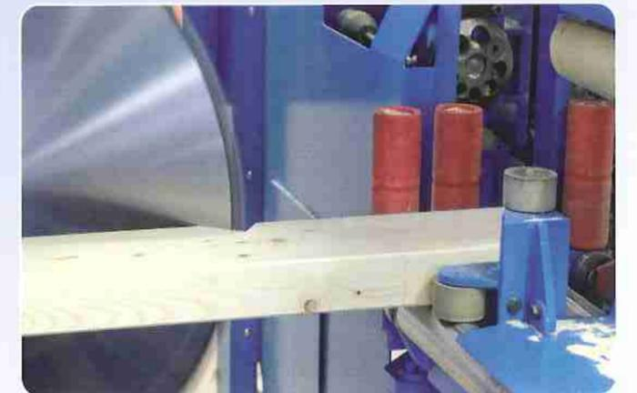
Entailles, entailles montantes ou têtes de chevrons et mi-bois peuvent être réalisés grâce à la mise au point de ce tout nouveau agrégat de sciage.
