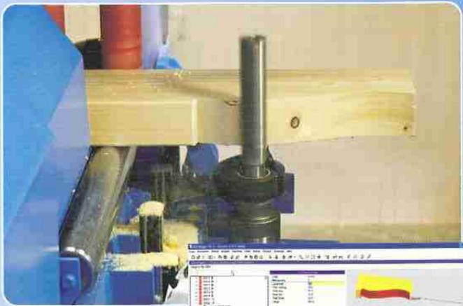
Avec la fraise verticale (qui peut être équipée de divers outils), vous réalisez des rainures, des mortaises, des profils de toute sorte, etc. Les perceuses à rajouter à tout moment, permettent la réalisation de toutes sortes de perçages (par ex. perçages borgnes).
