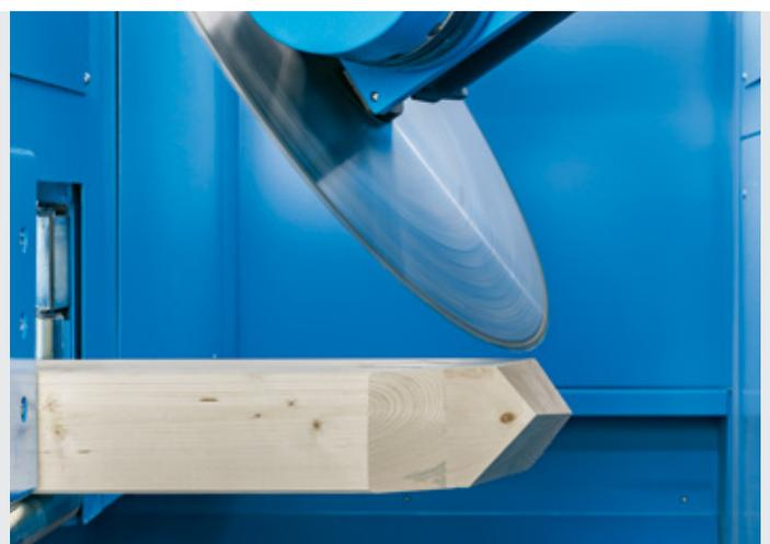
Längsschnitte, Abgratungen oder Auskehlungen werden mit dem Ø 720 mm Sägeblatt gefertigt.
