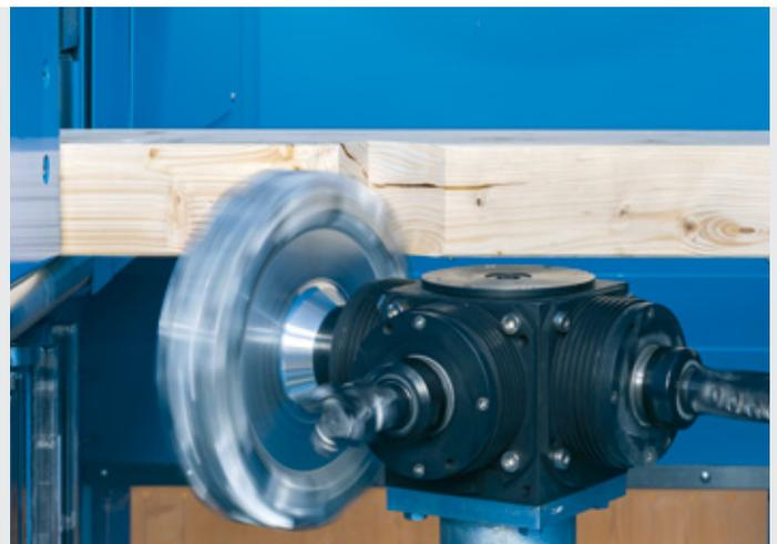
Kerven können effizient gefräst werden – ausrissfrei.
