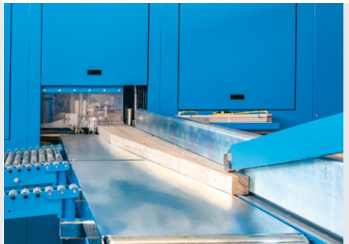
Kontrollierter Werkstücktransport mit dem stabilen Greiferwagen.
