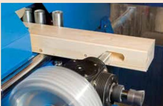
Avec l'agrégat de fraisage revolver, réalisez perçages, tenons et mortaises à chaque bout de la pièce.
