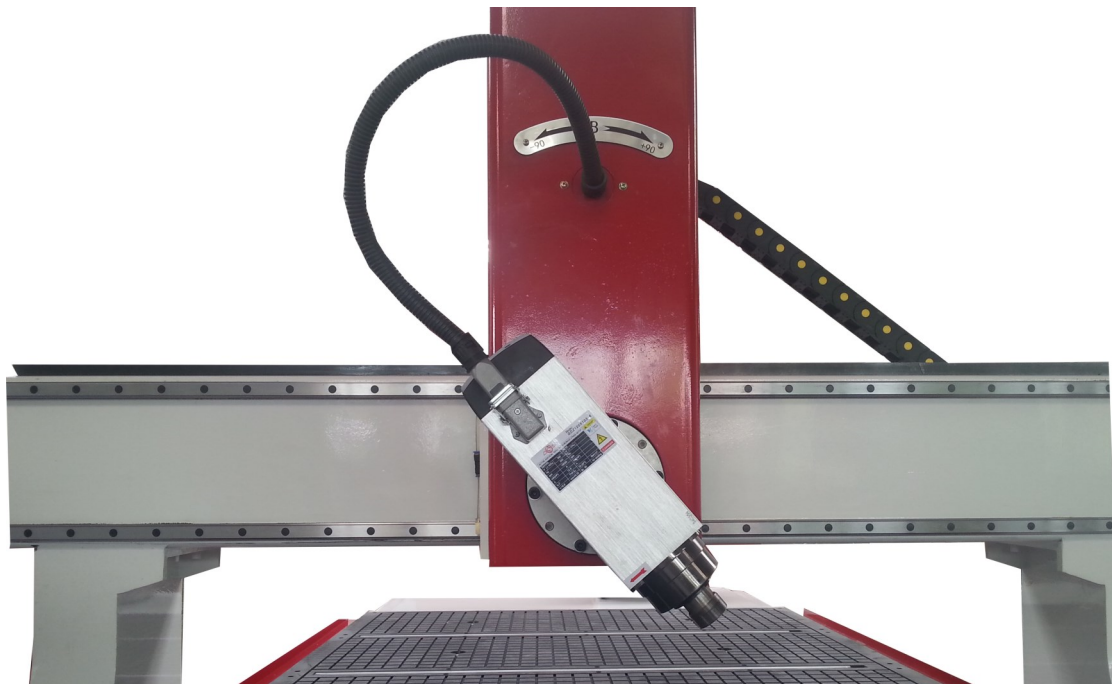
Bild 8. Frässpindel luftgekühlt je 5.5 KW - +/- 90° parallel zu X-Achse schwenkbar
