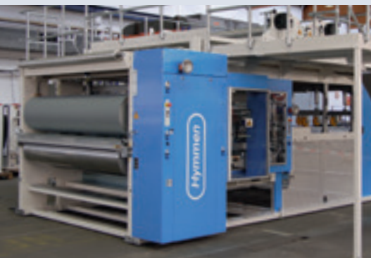
CTK mit einem Gummikalander zum Kaschieren von Sonderfolien
