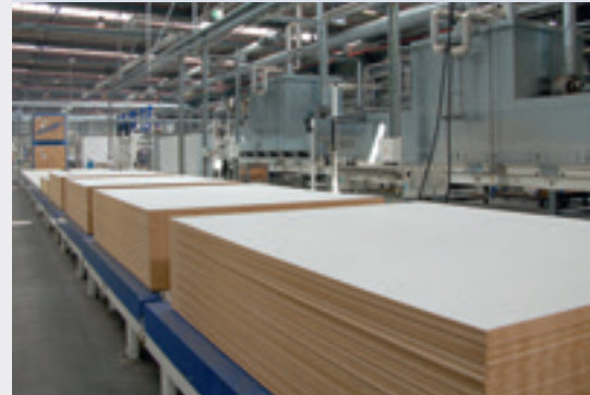
Laminierte Rohplatten vor der Imprägnierung und dem (dekorativen) Finishing
