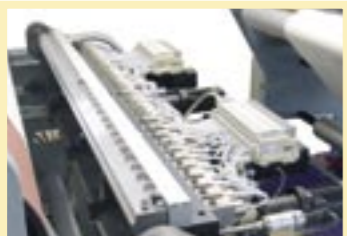
Flächenauftragskopf mit elektropneumatischer Steuerung für kontinuierlichen Auftrag. Optional mit verstellbarer Auftragsbreite.
