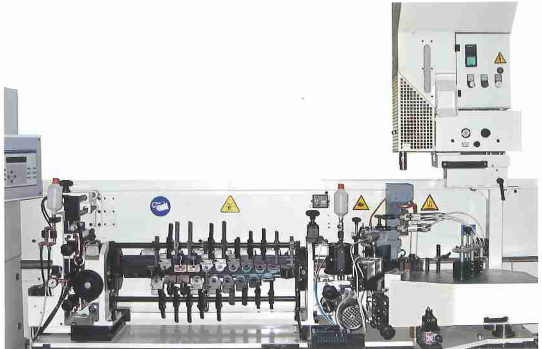
Softforming gluing unit Softforming Aufleimaggregat
