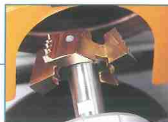
Multifunctional fine trimming unit Vielfaches Fase- und Radiusfräsaggregat
