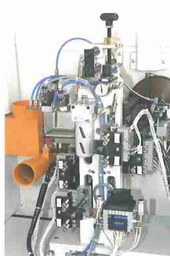
Multifunctional edgescraping unit Vielfaches Radius-Ziehklinsenaggregat
