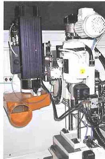
Grooving unit with HSK quick release device Fräsaggregat mit Werkzeugschnellösung HSK
