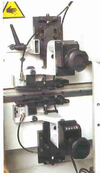
Scraping unit Zieh Klinge entfernt überstehende Kanten
