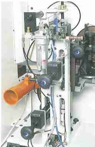
Edgescraping unit Radius-Ziehklinsenaggregat
