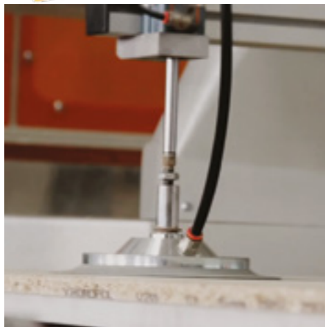
✓ Przysawki transportujące płyty meblowe bez zarysowań
