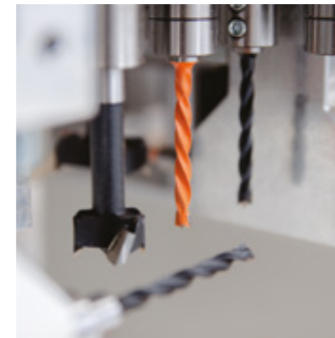
✓ Zestaw wiertel nieprzelotowych prawo i lewo stronne oraz wiertła puszkowe
