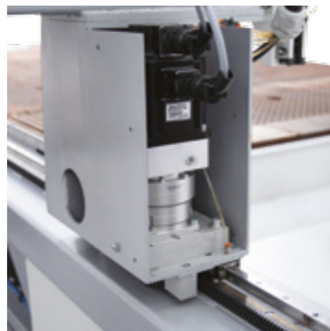
✓ Serwonapęd AC wraz z bezluzową jednostopniową przekładnią planetarną
