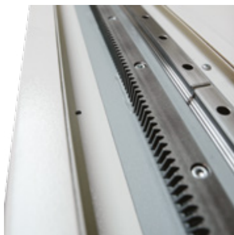
✓ Stalowe listwy o skośnym szlifie oraz prowadnice liniowe marki Bosch Rexroth
