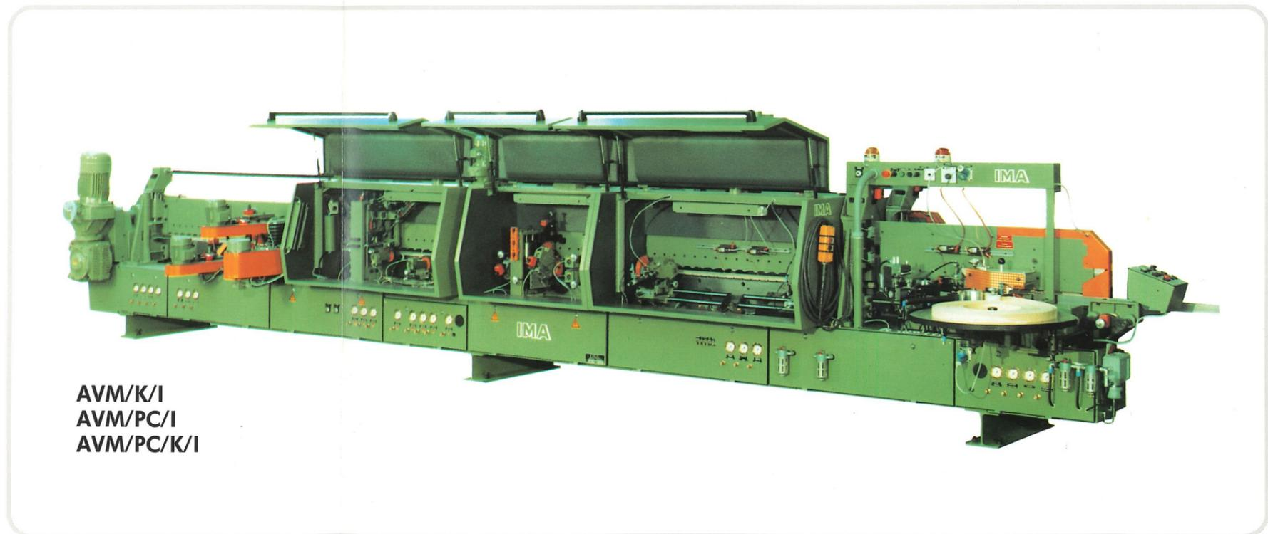
Kantenverleimen mit **Kunstharzschmelzklebern** oder **Spezial-PVAc-Leimen** und Kanten nachbearbeiten. Für min. ca. 65 und max. ca. 2500 mm breite Werkstücke. Je nach Bestückung mit Aggregaten können Furnier/Kunststoffstreifen abgelängt oder als Rollenware und Massivholz-
